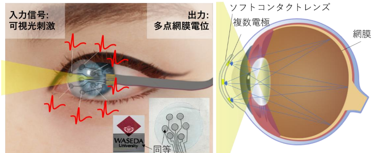
図1. 透明で柔らかいマイクロ電極による多電極網膜電位計測システム
